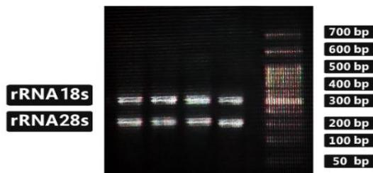
شکل ۱- بررسی RNA استخراج شده با استفاده از ژل آگارز
